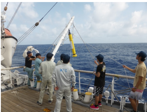
アルゴフロート投下の様子（遠洋航海中の帆船海王丸にて） 2018年5月
