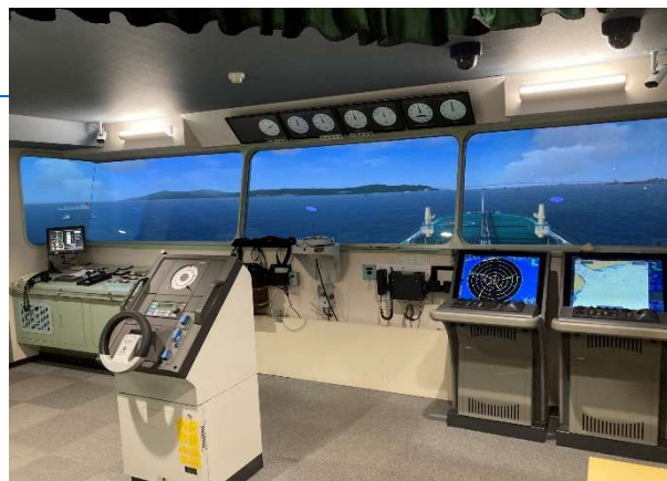
第3実習実験棟 第一操船シミュレータ
