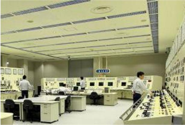
図3 BTCシミュレータ（BWR訓練センター）
