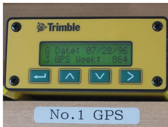
図1 GPS ロールオーバー発生状態
