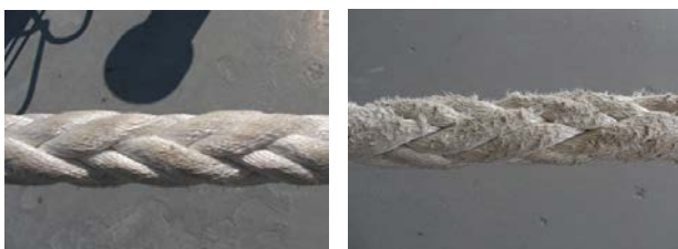
図2 合成繊維ロープの外層摩損の評価サンプル
